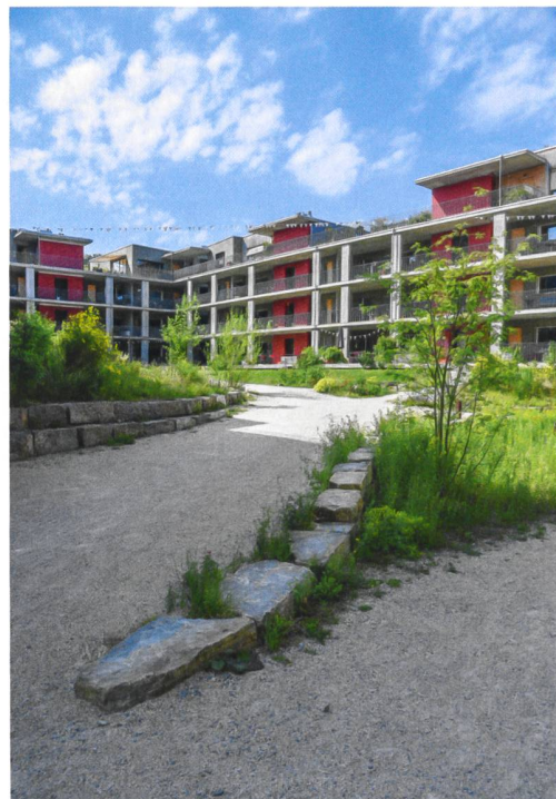
Links: Mergelwege erschliessen das leicht abfallende Gelände. Auf eine Begradigung des Hangs hat man verzichtet, um den trennenden Charakter einer Terrassierung zu vermeiden. Rechts: Grosse rohe Steinquader stabilisieren das Erdreich.
