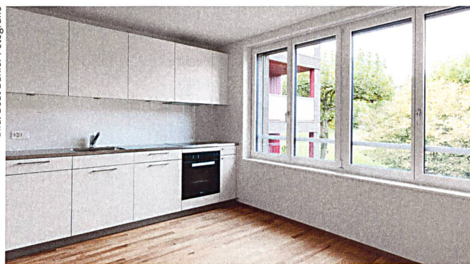
Zwei Hauptwohnräume sind als «fliessender Raum» angeordnet. Deshalb wählte man auch im Küchenbereich Parkett, und zwar in der geölten Ausführung (ABZ, Siedlung Balberstrasse 2, Zürich, 2015; Architektur: raumfindung architekten eth bsa sia, Rapperswil).
