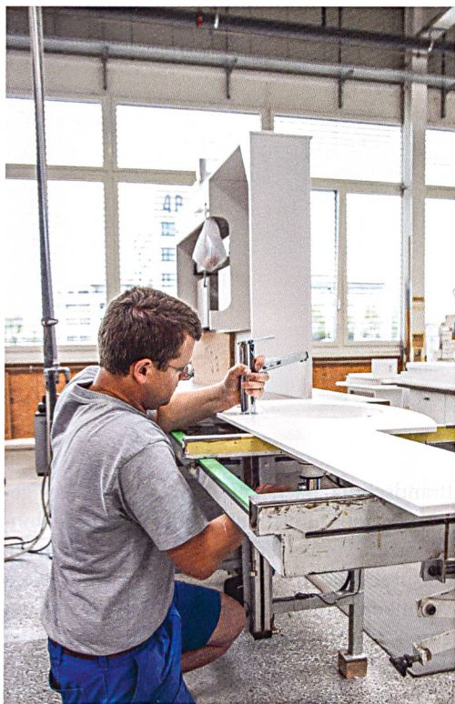
Vorwand und Möbel werden im Werk bereitgestellt, auf die Baustelle geliefert und dort montiert (im Uhrzeigersinn von links). Innert zehn Arbeitstagen können so 24 Bäder erneuert werden.
