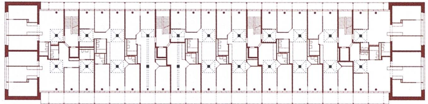
Über sieben Geschosse beherbergt das Wohnhaus 64 Wohnungen mit eineinhalb bis sieben Zimmern. Die Pilzstützen bilden den wichtigsten Ausgangspunkt des Entwurfs. Im ersten und zweiten Obergeschoss geben sie in den Wohnungen den Grundriss vor.
