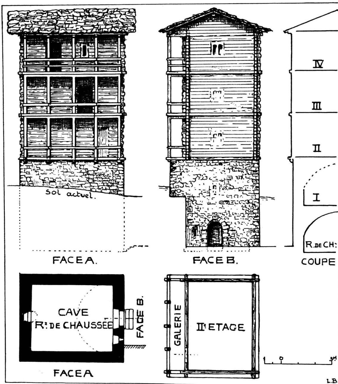
Fig. 5. Plan et élévation du ballios de Vissoie
