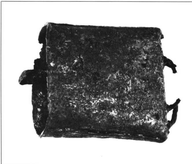
Abb. 4 Schelle aus Eisen, aus dem Mühlebachthal von Oberwil b.Zug, ca. 18. Jh. Nach der zweimaligen Plasmabehandlung ist die Oxidschicht im Hohlraum der Glocke vollständig reduziert. Dadurch ist der Klöppel wieder frei beweglich. Die seitlichen Kupferlotstellen und die verzinnete Oberfläche sind gut erkennbar.
