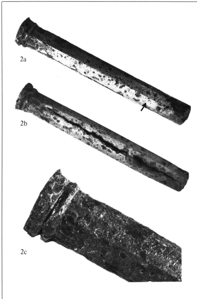
Abb. 2 Handfeuerwaffe von Freienstein nach der Plasmabehandlung und nach der Freilegung der Oberfläche. a) Gesamtansicht, b) Gesamtansicht der wahrscheinlich wegen Überladung mit Schiesspulver geplatzten Seite, c) Detail: vorderer Teil des Laufes mit Mündung (vgl. Abb. 1b).
