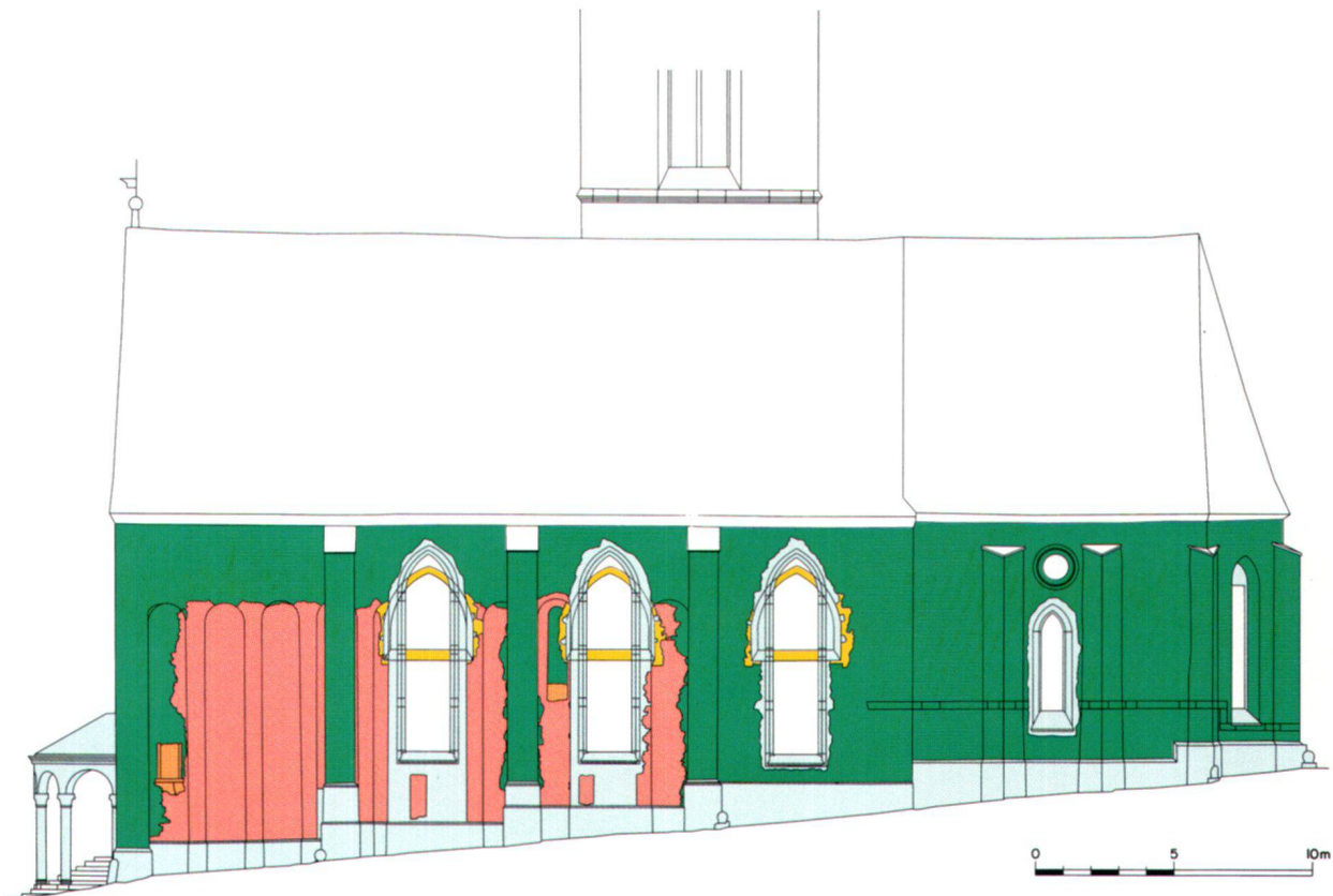
Abb. 14 Südfassade mit den einzelnen Bauphasen. Masstab 1:300 (Farblegende vgl. Abb. 18).
