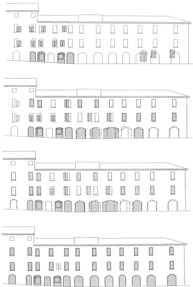
Fig. 10 Le diverse fasi costruttive ('400, '600, '700, '800) lette attraverso le aperture su via San Damiano.
