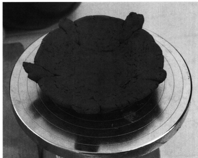
Abb. 6 Einsetzen der Tonkeile.
