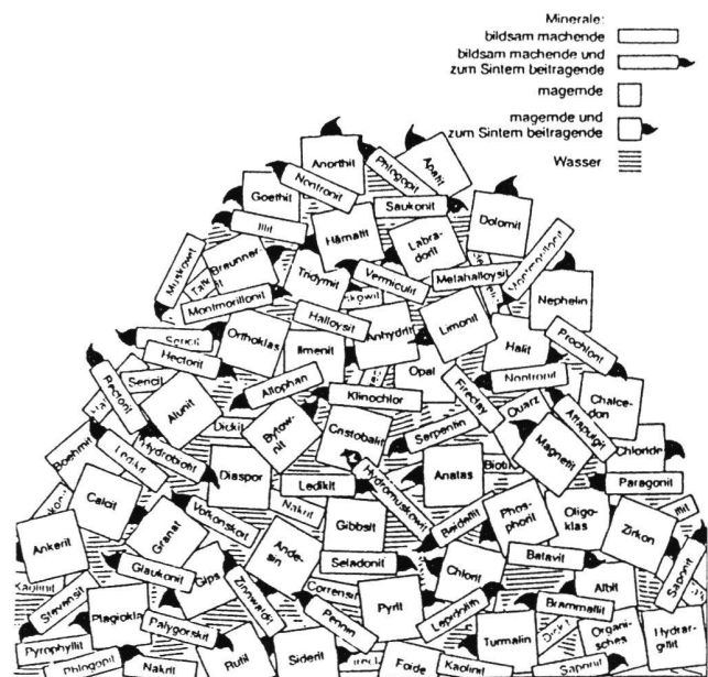
Abb. 1 Zusammensetzung von Ton.
