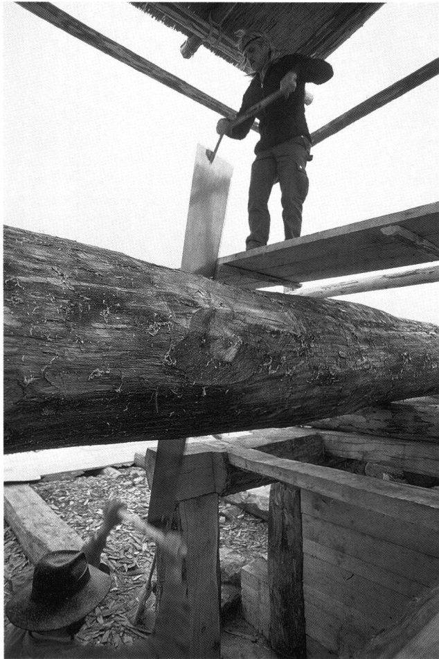
Fig. 3 Sciage de long à l'aide d'un cran.
