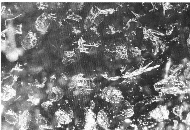
Abb. 7 Detailansicht des Tropfenfängers von Abb. 6; nadelige Natriumformiatkristalle auf der Glasoberfläche. Breite des Ausschnitts ca. 7 mm.
