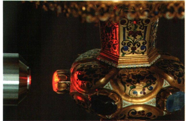
Fig. 3 Analyse par spectrométrie Raman en utilisant le laser rouge (633 nm) d'un saphir du ciboire.
