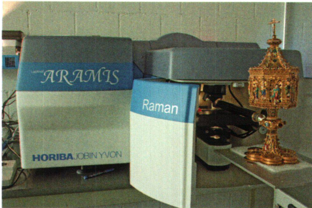
Fig. 2 Analyse par spectrométrie Raman des pierres colorées du ciboire.
