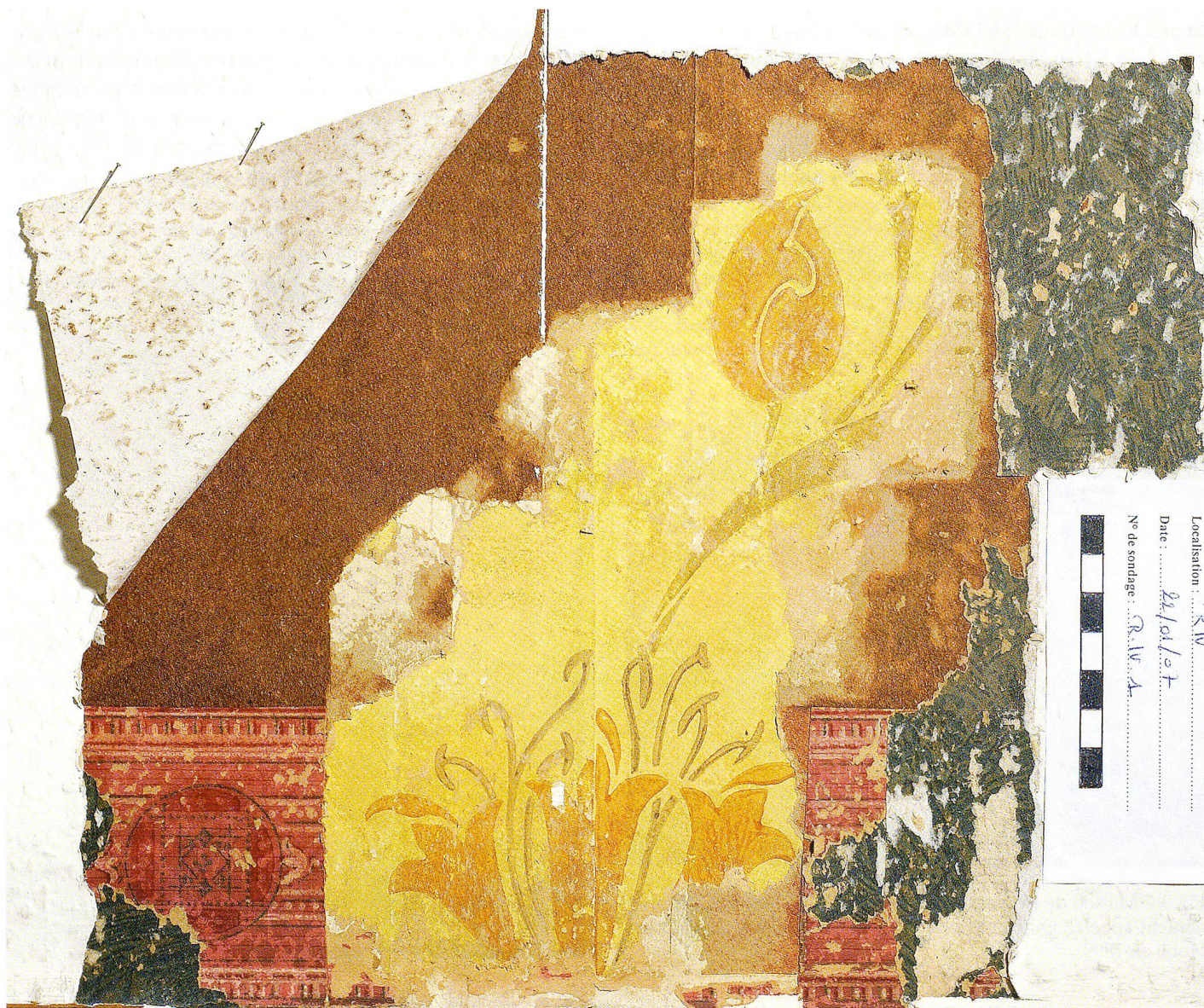
Fig. 3 Stratigraphie réalisée au niveau du mur des bureaux du rez-de-chaussée mettant en évidence une succession de cinq couches de papier peint.
