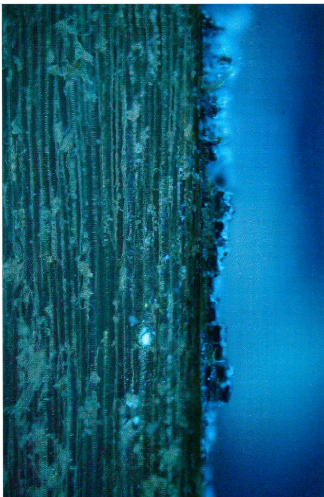
Abb.8 Gleicher Querschnitt wie in Abb.7. Aus der Oberfläche ist noch eine hell fluoreszierende Schicht zu sehen, die von einem Wachs stammen kann (Spritzer von Kerzen?). Querschnitt in 200-facher Vergrösserung, UV-Licht.
