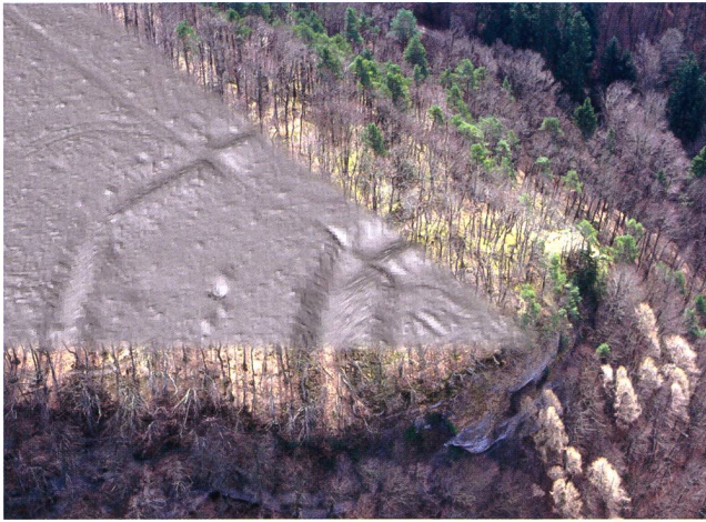
Abb. 7 Weiach-Leuenchopf ZH. Die Kombination von Luftbild und LiDAR-3D-Modell verdeutlicht nebst einer doppelten Wall-Graben-Konstruktion unbekannter Zeitstellung auch das Potenzial dieser Methode.
