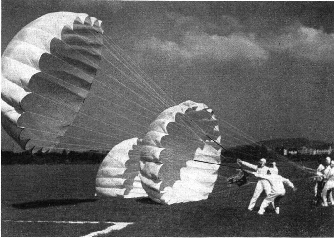
Wieder auf der Erde. Im Moment der Landung muss der Schirm raschestens eingezogen werden, weil er sonst wie ein riesiges Segel weiter treibt und den Springer nach sich zieht. Der Fallschirm wird aus leichter, besonders widerstandsfähiger Seide oder Baumwolle hergestellt. Er wird aus 20—24 Bahnen fest zusammengenäht und durch Quernähte versteift. Der Durchmesser beträgt 7- 8 Meter, die Oberfläche etwa 40—55 Quadratmeter, das Gewicht rund 8 Kilo.
