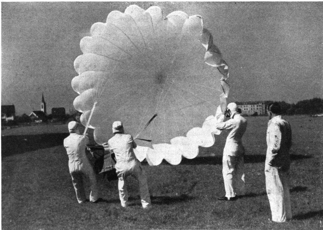
Der Fallschirm wird heute nicht nur für die Rettung von Fliegern verwendet. In fast allen Kriegsländern bestehen ganze Heereseinheiten von Fallschirmabspringern. Sie gehören zu den Elitetruppen des Heeres. Der Fallschirm besteht aus 18—24 Reissbahnen, diese werden aber nicht gerade, sondern diagonal geschnitten, um die Festigkeit zu erhöhen. Vom Ende des Schirmes führen je nach Art 18—24 dünne Seile zum breiten Traggurt, der den Körper des Fliegers fest umschliesst.
