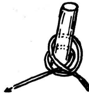
Der Mastwurf zum Befestigen von Seilen an Pfählen und Balken. Dieser Knoten kann durch einen Schifferknoten gesichert werden.
