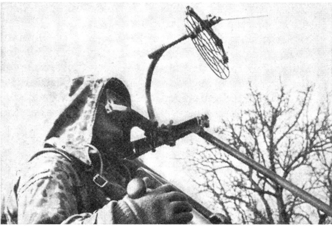
Ungenügend ist die Bewaffnung mit Fliegerabwehrwaffen. Hier ein Kanonier an der Flakkanone 20 mm M-58, der sogenannten Oerlikon-Kanone
