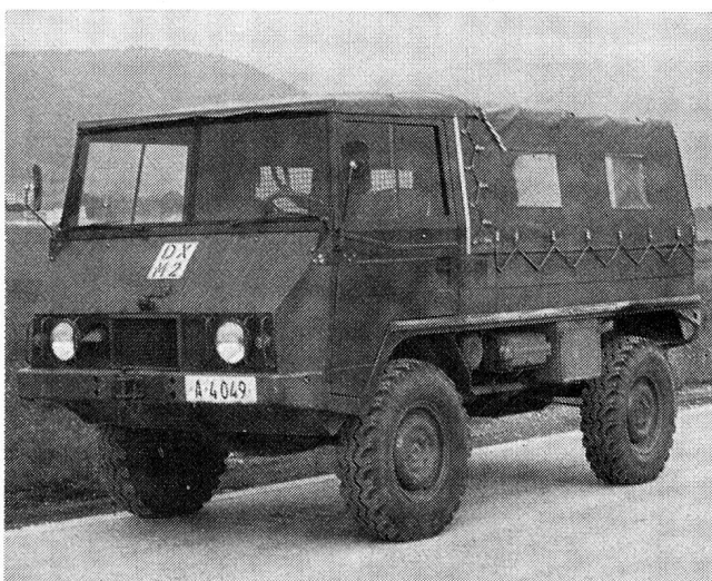
Abb. 14. Leichtes Mehrzweckfahrzeug Pinzgauer 1,0 t 4 × 4
