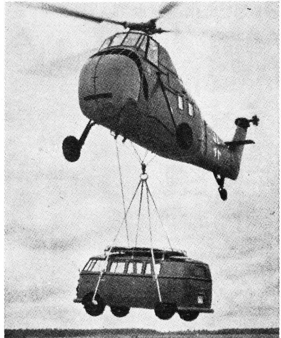
Hubschrauber-Verlastung eines fahrbaren Trinkwasserbereiters (VW-Kombi)
