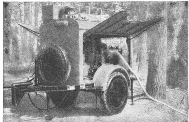
**Trinkwasserbereiter 0920 ABC** Die Gemeinde Kilchberg hat ihre Zivilschutzorganisation mit einem solchen Gerät ausgerüstet. In Katastrophenfällen, auch bei A, B und C-Verschmutzungen kann nun die Bevölkerung mit Trinkwasser versorgt werden. Berkefeld-Trinkwasserbereiter sind in verschiedenen Armeen und ausländischen Bevölkerungsschutzorganisationen eingesetzt.
