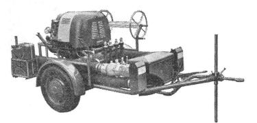
Höchstleistung bei 80 m GMF: zirka 1600 I/min Motor VW-Industrie, 44 PS bei 3600 T/min
