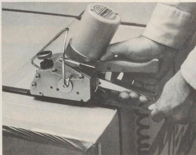
Ein treuer Helfer ist bestimmt der elektrische **strapex**-Vibrospanner. Er arbeitet für Sie und wird nie müde, Sie brauchen bloss das Kunststoff-Umreifungsband einzulegen. Die restliche Arbeit können Sie dann ruhig dem Vibro überlassen. Er spannt "wie der Blitz" und schliesst die Umreifung mit dem sichersten Schweissverschluss ab. Mühelos, schnell und ohne teure Plomben (PTT-konform). Verlangen Sie eine unverbindliche Demonstration!
