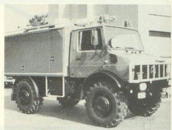
Unimog U 1700 (168 PS), ausgerüstet als Schlauchwagen für die Flugplatzfeuerwehr Kloten.
