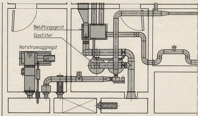
*Installationsplanung.* Für Gasschutzbelüftung und Notstromversorgung. Leistungen und Honorare gem. SIA 108.
