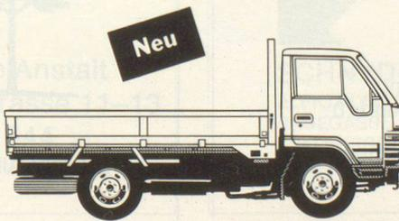
**Dyna:** 2 Türen, 3 Plätze, 4-Zylinder-Benzinmotor, 1998 cm<sup>3</sup> und 65 kW (88,4 PS) DIN. Kippkabine. Als Brückenwagen (Nutzlast 1640 kg) und Chassis-Kabine mit 2 Radständen erhältlich. Chassis-Tragfähigkeit: 1930 kg. Ab **Fr. 23 750.-**.
