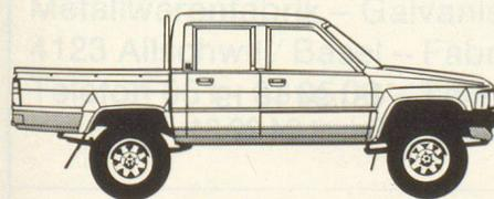
**Hilux 4 x 4:** 5-Gang-Getriebe, jederzeit zuschaltbarer Allradantrieb, Gelände-Untersetzung auf allen fünf Gängen und Sperrdifferential hinten. Mit 4-Zylinder-Benzinmotor: 1998 cm<sup>3</sup>, 65 kW (88,4 PS) DIN. Nutzlast 1135 kg. Lieferbar als Chassis-Kabine, Pickup oder mit Doppelkabine (4-Gang-Getriebe). Ab **Fr. 21 200.-**. Pickup auch mit Dieselmotor (2446 cm<sup>3</sup>) und 1020 kg Nutzlast. **Fr. 23 990.-**.
