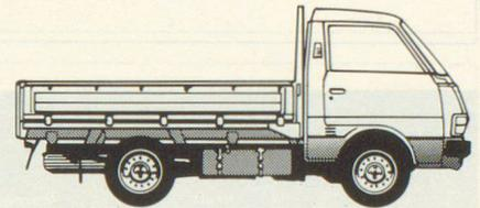
**Hiace 1600:** 4-Zylinder, 1587 cm<sup>3</sup>, 48,5 kW (66 PS) DIN, mit 4-Gang-Getriebe, als Chassis-Kabine, Brückenwagen und Doppelkabine bis zu 6 Plätzen lieferbar, Chassistragfähigkeit: 1460 kg. Nutzlast bis zu 1250 kg. Ab **Fr. 16 600.-**.
