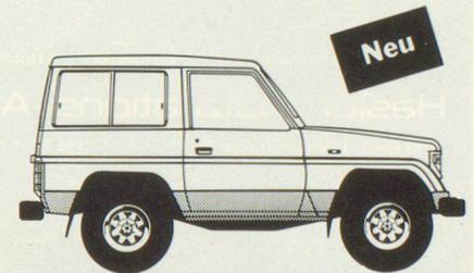
**Landcruiser II 4 x 4 Hard- und Soft-Top:** 3 Türen, 5 Plätze, 4-Zylinder-Dieselmotor, 2446 cm<sup>3</sup>, 53 kW (72 PS) DIN, 5-Gang-Getriebe, jederzeit zuschaltbarer Allradantrieb, Geländeuntersetzung auf allen Gängen, Sperrdifferential und Freilaufnaben, Servolenkung, Nutzlast 420 kg resp. 450 kg, geprüfte Anhängelast 3000 kg. Ab **Fr. 27 950.-**.
