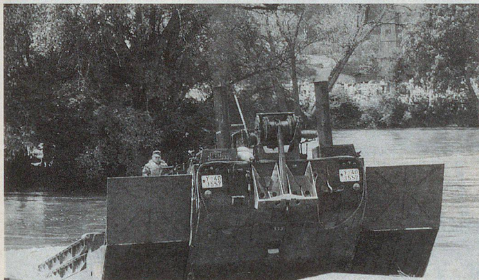
Ein Amphibienfahrzeug geht mit ausgeklappten Seitenschwimmern zu Wasser.
