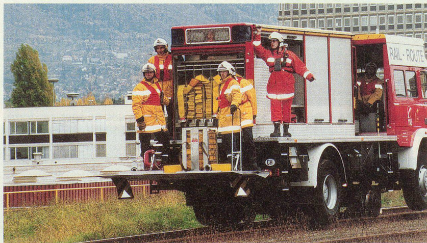
Le véhicule rail-route du SIS.
