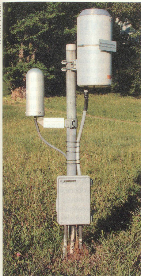
Station Nadam, mesurant la radioactivité.
