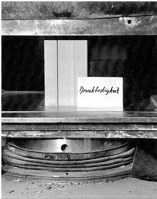
Abb. 1 Versuchseinrichtung der Druckfestigkeitsprüfung.
