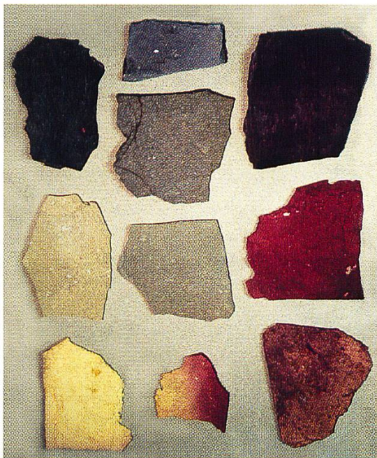
Abb. 14 Auswahl natürlich gebrannter Tonschiefer. Das Farbspektrum zeigt die farbliche Diversität des reduziert gebrannten Tonschiefers nur unvollständig.
