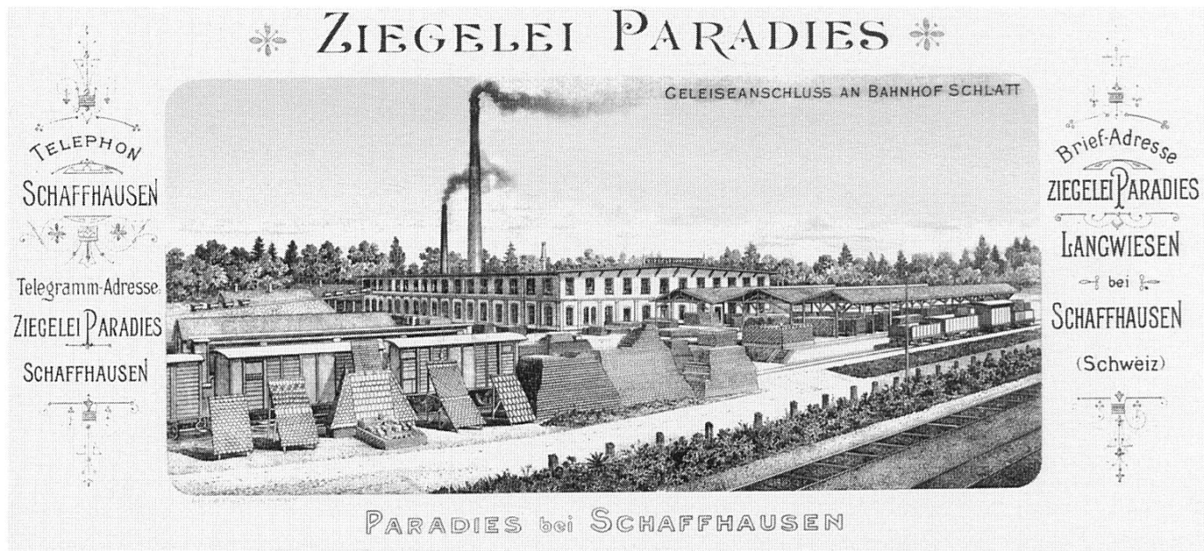
Abb.5 Vedute der Ziegelei Paradies von Südwesten mit den Gleisanlagen im Vordergrund. kennt man das Bahnhofsgebäude von Schlatt und davor eine Dampflokomotive. Im Juli 1899 erteilt die Ziegelei Paradies der Schweizerischen Nordostbahn den Auftrag, für ihre Fabrik einen direkten Gleisanschluss zu bauen, damit die gebrannten Waren direkt auf dem Ziegeleigelände verladen und abtransportiert werden können (Abb. 5). 8
