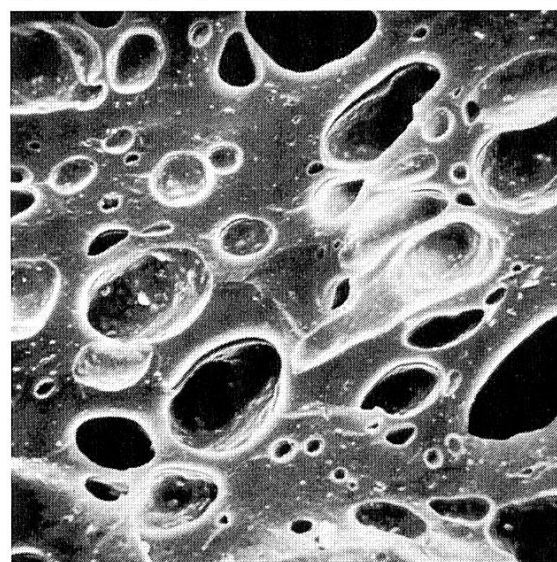
Abb. 5 Glasartiger Charakter der Dachziegelmischung bei Garbrand auf 1050 °C; 800-mal vergrössert.
