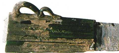
Abb. 38, 39 Ravensburg, Grüner Turm, Reparatur- ziegel 1875, Typ I (MST 1:8), und Grat- ziegel, beide signiert vom Ravens- burger Hafner Johann Georg Huber.
