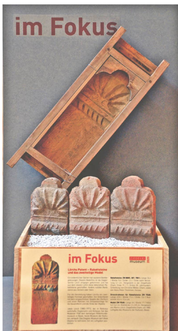
Rabattsteine, die aus der zweiteiligen Holzstreichform der Ziegler Lörch stammen. Leihgabe des Museums der Kulturen, Basel, ZM 9568. Foto Lucia Zurbrügg.
