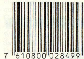
Immer mehr Verpackungen weisen das rechteckige Strichzeichen, den sogenannten EAN-Code auf (EAN ist die Abkürzung für «Europäische Artikel-Nummer»). Dieser Artikel-Code ermöglicht die maschinelle Einlesung an der Kasse, soweit diese mit einem Scanner (to scann = abtasten) ausgerüstet ist. Der Code besteht aus 13 Ziffern, die für das Lesegerät in Strichen und Zwischenräumen dargestellt sind.
