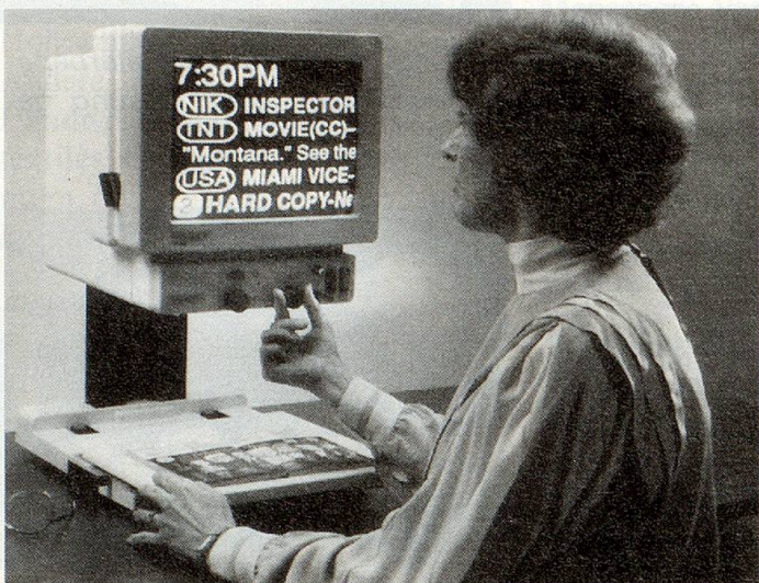
Technischer Fortschritt auch bei den Hilfsmitteln: Vierzigfache Vergrösserungen sind bei diesem Bildschirm-Lesegerät möglich.
