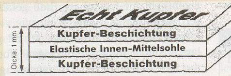
Querschnitt der Sohle 3-LAGIG
