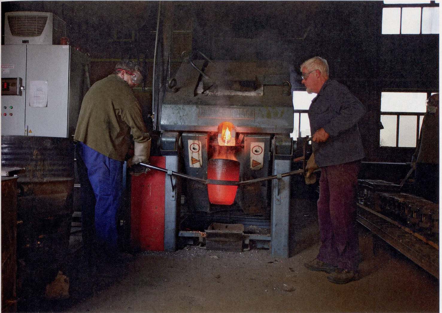
Giesserei Hans Gusset (in der grünen Jacke) und Peter Bilang (groses Bild) bereiten die Sandformen vor, dekorieren sie mit verschiedenen Stempeln und giessen die heisse Bronze hinein.
