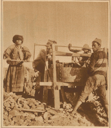
Eine von Hand getriebene Maschine zur Zerkleinerung des edelsteinhaltigen Gesteins
