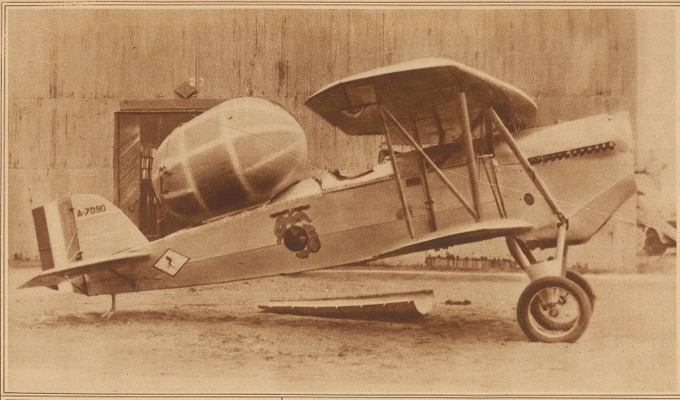
Ein Rettungsballon für Flugzeuge. Für Flugzeuge ist eine neue Sicherung getroffen worden, die vor allem auch für Ozeanflüge zur Anwendung kommen soll. Auf dem Apparat wird ein Ballon montiert, der im Augenblick der Gefahr mit Gas gefüllt werden kann und der für den Fall, daß das Flugzeug auf soltene Wasser niedergehen muß, instande ist, die Maschine mit den Passagieren über Wasser zu halten, bis die Rettung erfolgen kann
