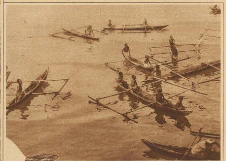
Bei der Anbnft des Dampfers kommen ganze Schwärme kleiner Auslegerboote ans Schiff herangerudert. Die im Bilde ersichtlichen Ausleger verbinden das Usskippen der schmalen Boote
