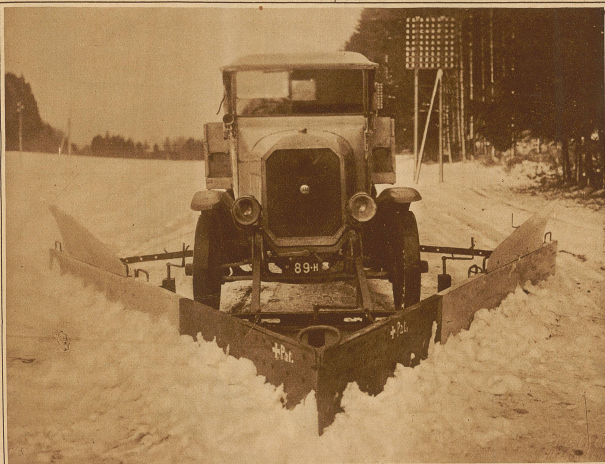
Ein neuartiger, durch einen Lastwagen angetriebener Schneepflug, der letzte Woche anlässlich einer Probefahrt die Strecke Zürich-Uster-Weiskönig
