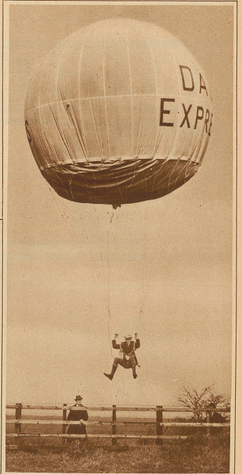
Das Ballonspringen, ein neuer Sport. Die Hülle wird nur so weit mit Gas gefüllt, daß der Ballon den Menschen nicht ganz zu tragen vermag, daß aber die Sprungkraft der Beine doch genügt, um Sprünge von über 100 m zu erreichen
