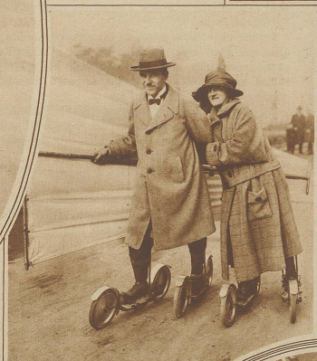
Unteres Bild: Ein neuerlicher Verkehrs- und Sportrellschuh, der nach einiger Übung rasche Fortbewegung erlaubt. Bei windigem Wetter kann auf offener Strecke mit Vorteil ein Handsegel zum Antrieb verwendet werden
