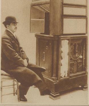
Endlich ist es gelungen, das vielfach versuchte Problem des sogenannten «Photographischen Automaten» zu lösen. Der Erfinder hat einen Apparat konstruiert, in dem man ein Geläut einwirft, wodurch automatisch die Aufnahme gemacht und durch Entwickler, Fixierbad und Wässerung geführt wird, bis nach circa 4 Minuten der fertige Abzug herauskommt. Wie lange wird es wohl gehen, bis diese Apparate an allen Straßenecken stehen?
