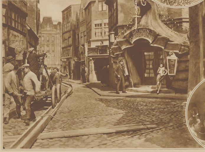
Unteres Bild: Die fahrbare Kamera läuft auf Holzbahnen, damit die Aufnahmen nicht verwackeln, was bei einer Bewegung auf dem Kopfsteinpflaster nicht zu vermeiden wäre
