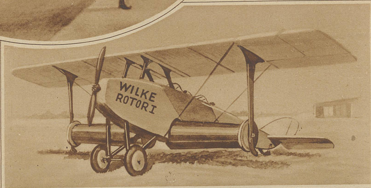
disigkeit angetrieben, sind also im Gegensatz zum Flettnerschiff von den Windverhältnissen unabhängig. Vermöge der starken Auftriebskraft der Rotore kann das Flugzeug ohne großen Anlauf aufsteigen, also auf ganz beschränkten und ungunstigen Plätzen starten und landen. Die Rotore sind in stromlinienförmige kleine Flächen, sogenannte Lamellen, unterteilt, die beim Stillsetzen der Rotore selbsttätig aufklappen und tragflächenartig wirken, so daß auch die Manövrierfähigkeit des Flugzeuges bei etwa versagendem Motor gewährleistet ist
