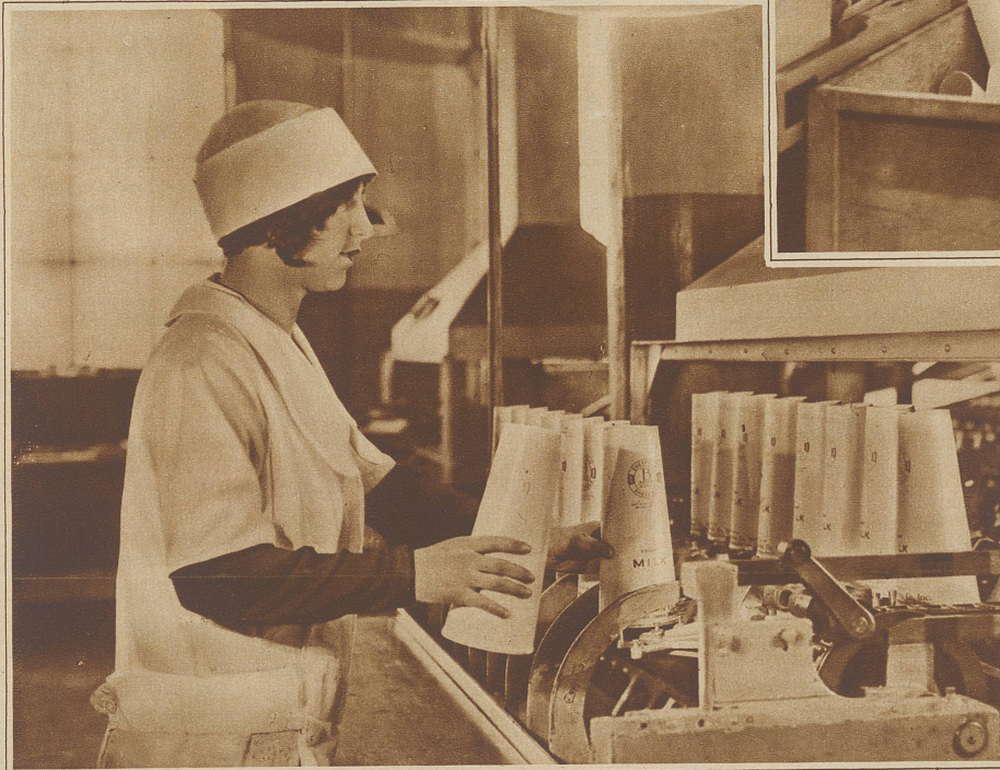
Sterilisierung durch ein Paraffinbad mit anschließender Luftkühlung
